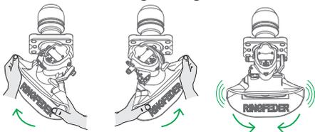
Das Kuppelkörper muss mithilfe der Federkräfte in die Mittelstellung zurückkehren.
